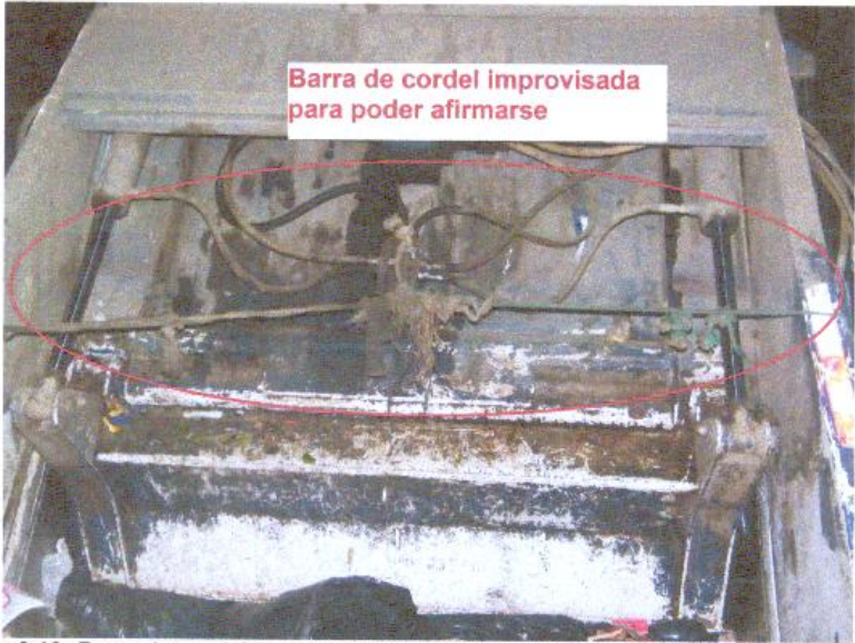
Foto n° 10: Barra de cordel improvisada por los mismos trabajadores para su seguridad.
